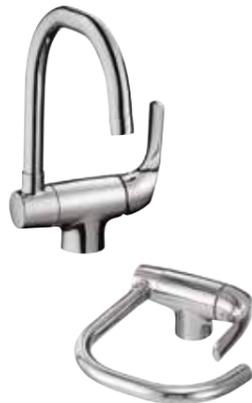
**E76250-CP Natéo - Mitigeur évier, bec tube orientable et rabattable** pour installation devant une fenêtre, avec flexibles d'alimentation PEX. Bague-limiteur de température. Economiseur d'eau : butée sensitive. Aérateur anticalcaire. Débit : 9 l/mn. Percement Ø 35 mm
