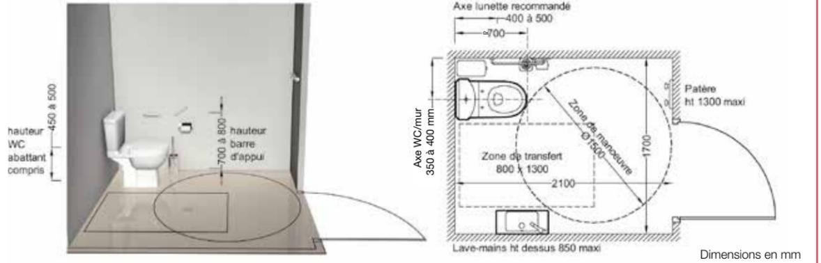
Pour les permis de construire déposés après le 1<sup>er</sup> juillet 2017, la distance entre l'axe de la cuvette de WC et la barre d'appui latérale est comprise entre 400 et 450 mm.
