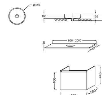
La collection Parallel est possible en installation PMR. Les plans de toilette sont disponibles en version standard ou sur mesure de 60 à 200 cm, en stratifié.
