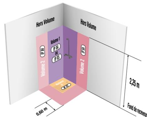
Note : la pose d'un receveur de douche permet de contenir le volume 1 et donc de réduire la surface de la salle de bains contrairement à une douche carrelée ou en PVC.
