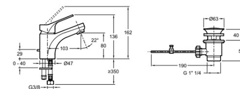
**NF E78111-4-CP Mitigeur lavabo avec cartouche C3 - Système d'installation 5'35**
