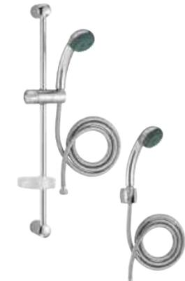
**E14325-CP Basic 1 - Ensemble de douche avec barre métallique de 0,60 m, porte-savon.** Flexible métallique double agrafage anti-torsion 1,75 m et douchette 2 jets anticalcaire. 3 réducteurs de débit : -20 %, -30 %, -50 %.
