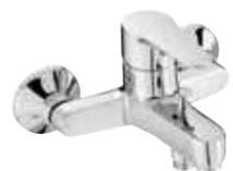
**NF E16033-4-CP Mitigeur bain-douche mural** avec inverseur automatique verrouillable. Limiteur de débit sensitif. Bague-limiteur de température. Clapet anti-retour sur sortie douche. Raccords et rosaces murales. Aérateur anticalcaire. ECAU : E3/1 C2 A2 U3
