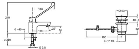
**E16024-4ND-CP Mitigeur lavabo July avec levier Easy. Corps lisse, sans tirette et sans bonde de vidage.** Levier Easy à commande au coude de 150 mm monté en usine. Cartouche séquentielle (ouverture/fermeture et réglage par déplacement horizontal du levier).
