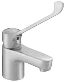
**E16024-4-CP - Mitigeur lavabo July avec levier Easy.** Levier Easy à commande au coude de 150 mm monté en usine. Cartouche séquentielle (ouverture/fermeture et réglage par déplacement horizontal du levier). Température maximale préréglée à 40°C en usine (avec alimentation en eau chaude à 62°C et eau froide à 12°C sous 3 bars). Tirette latérale. Bonde de vidage en métal. Aérateur anti-calcaire. Flexibles d'alimentation PEX haute résistance.
