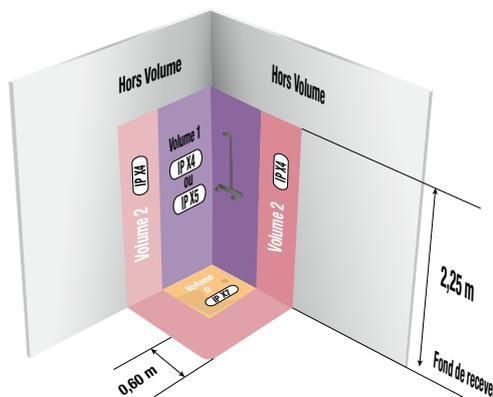
Note : la pose d'un receveur de douche permet de contenir le volume 1 et donc de réduire la surface de la salle de bains contrairement à une douche carrelée ou en PVC.
