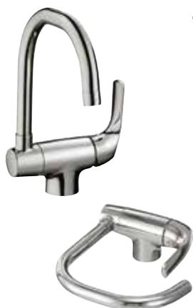
**NF** **E76250-CP Natéo - Mitigeur évier, bec tube orientable et rabattable** pour installation devant une fenêtre, avec flexibles d'alimentation PEX. Bague-limiteur de température. Economiseur d'eau : butée sensitive. Aérateur anticalcaire. Débit : 9l/mn. Percement Ø 35 mm
