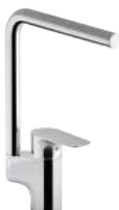
**E72360-CP Aleo - Mitigeur évier, bec tube, avec lexibles d'alimentation PEX.** Bec tube orientable. Bague-limiteur de température. Aérateur anti-calcaire intégré. Percement Ø 35 mm. Débit limité à 8 l/mn
