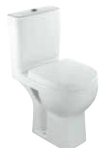
**E0374-00 Odéon Up - Pack WC compact sortie horizontale** 60 x 36,5 cm. Hauteur confort 43 cm. Réservoir réversible complet monté en usine, avec mécanisme double chasse 3/6 L à bouton poussoir chromé. Robinet flotteur silencieux. Alimentation latérale. Système de montage rapide. Kit de fixation.
