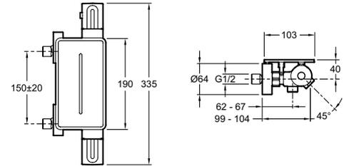
**Recommandation :** l'installation murale est recommandée pour une largeur de plage de la baignoire jusqu'à 105 mm ; au-delà, privilégier l'installation sur colonnettes universelles E75456-CP. **Installation optimale à 12 cm au-dessus de la baignoire.**
