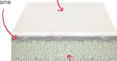
Bloc de particules haute densité composé de bouteilles plastiques recyclées. Ce matériau est utilisé dans l'architecture et les pales d'éoliennes pour son excellent rapport poids/résistance.
