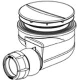
**E78161-CP Bonde** haut débit spécialement étudiée pour receveurs extra-plats. Non compatible avec receveurs céramique. Débit 54 L/min. Garde d'eau 50 mm.
