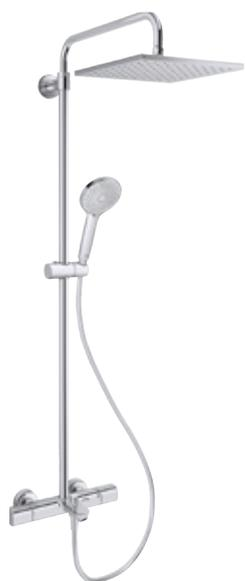
**E35680-9-CP Finition Chrome douche de tête ronde Ø245 mm.** Économie d'eau - Butée escamotable à mi débit. Butée de confort à 38°C. Température maxi inférieure à 50°C. Corps tiède. Inverseur intégré dans la poignée pour passage bain/douche de tête/bain. Inverseur bouton pour passage bain/douchette. Flexible lisse anti-torsion 1750 mm. Douchette à main Ø110 mm, 3 jets (débit 7 l/mn). Canne ajustable en hauteur à l'installation. Clapet anti-retour sur les alimentations.
