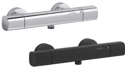
C3 - Économie d'eau. Butée escamotable à mi débit. Butée de confort à 38°C. Température maxi inférieure à 50°C. Corps tiède. Fourni avec raccords et rosaces murales. Clapet anti-retour sur les alimentations. EN OPTION : Tablette antiglisse déclinable (E24315).
