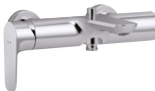
**E72282-CP Finition Chrome.** Inverseur automatique à bouton-poussoir. Aérateur anticalcaire pièce. Raccords et rosaces murales. Bague-limiteur de température. Limiteur de débit sensitif. ECAU : E3|1 C2 A2 U3 200 €
