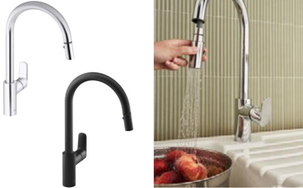
**E35687-4-CP Finition Chrome. Mitigeur évier, bec col de cygne orientable avec douchette extractible**, économie d'eau et d'énergie - butée sensitive à mi débit et démarrage eau froide. Douchette 2 jets (aéré / concentré). Fourni avec flexibles d'alimentation. Bague limiteur de température. Percement Ø35 mm. Débit limité à 10 l/mn.
