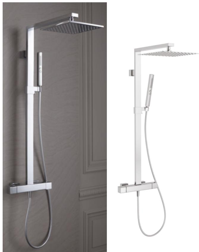
**E98321-CP Colonne de douche avec mitigeur thermostatique.** Douche de tête carrée en métal : 300 x 300 mm (débit : 10 l/mn) sur rotule. Butée de sécurité à 38°C. Température maxi inférieure à 50°C. Corps tiède. Poignées en métal. Inverseur sur poignée de débit du thermostatique. Coulisseau-support de douchette en métal, orientable. Flexible de douche lisse anti-torsion. Douchette à main Shift Square 2 jets avec boutons de sélection. Clapets anti-retour sur les alimentations.
