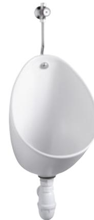
**NF E0399-00** Pack complet urinoir à effet d'eau 30 x 41,5 x 31 cm, fixations E4535, tube d'alimentation E74197, effet d'eau chrome, bonde et siphon polypropylène E74560, robinet temporisé G1/2 avec réglage de débit E74188.
