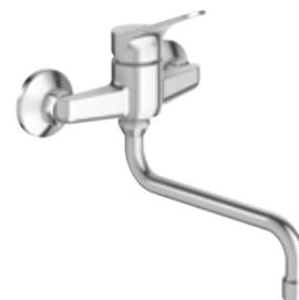
**E78114-CP Brive - Mitigeur évier mural - bec tube pivotant.** Cartouche C3 à économies d'eau et d'énergie. Bague limiteur de température. Aérateur anti-calcaire. Raccords et rosaces murales. ECAU : E0 C3 A1 U3
