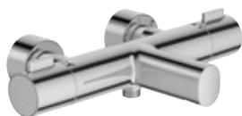
**E78520-CP Chrome.** Inverseur intégré dans la poignée de débit. Butée de sécurité à 38°C. Température maxi inférieure à 50°C. Aérateur anticalcaire intégré. Corps tiède. Poignées en métal. Clapet anti-retour sur les alimentations. Raccords et rosaces murales. ECAU : E3/I C3 AI U3
