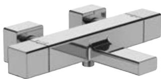
**E9127-CP Chrome** Mitigeur thermostatique bain-douche mural. Inverseur intégré à la poignée de débit. Butée de sécurité à 40°C. Température maxi inférieure à 50°C. Corps tiède. Clapets anti-retour sur les alimentations. Aérateur anti-calcaire intégré. Raccords et rosaces murales.
