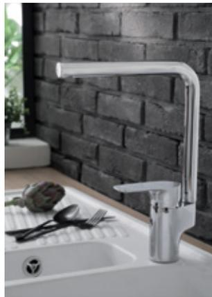
**E72360-CP Mitigeur évier, bec tube, avec lexibles d'alimentation PEX.** Bec tube orientable. Bague-limiteur de température. Aérateur anti-calcaire intégré. Percement Ø 35 mm. Débit limité à 8 l/mn
