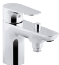
**E72284-CP Finition Chrome.** Avec flexibles d'alimentation. Bague-limiteur de température. Eco d'eau: butée sensitive. Inverseur automatique à bouton-poussoir. Flexibles d'alimentation (longueur 500 mm) avec raccords G1/2. Aérateur anti-calcaire "pièce". Clapet anti-retour sur la sortie douche. ECAU : E3|1 C2 A1 U3 214 €
