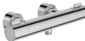
**E37035-CP Chrome.** Economiseur d'eau : Butée escamotable. Butée de sécurité à 38°C. Température maxi inférieure à 50°C. Corps tiède. Poignées en métal. Clapet anti-retour sur les alimentations. Raccords et rosaces murales. ECAU : EI C3 A3 U3
