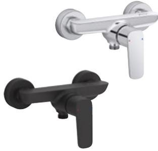
C2 - économie d'eau - Butée sensitive à mi débit. Inverseur automatique. Bague limiteur de température. Raccords et rosaces murales. Clapet anti-retour sur sortie douche. Aérateur anticalcaire.
