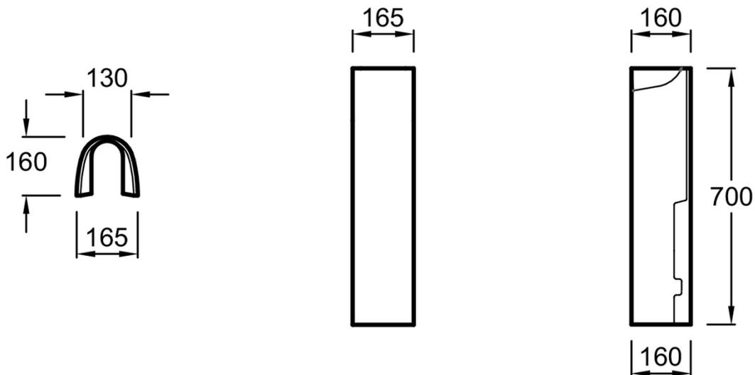
Descriptif CCTP : Colonne. 15537K. Collection : PATIO. POIDS : 9,4 kg. MATÉRIAU : Céramique. TYPE D'INSTALLATION : Posé. TYPE D'ACCESSOIRE : Colonne. DURÉE GARANTIE (ANNÉES) : 2.
