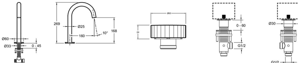
Descriptif CCTP : Mélangeur lav 3 trous - Std - Poignées Travertin Sable. CE25387-LM-HYE. Collection : GRANDS BOULEVARDS. POIDS : 1,0 kg. MATÉRIAU : Laiton. TYPE D'INSTALLATION : 3 trous. TYPE : Mélangeur. DÉBIT (L/MN SOUS 3 BAR) : 5 l/mn. RACCORDS : Avec flexibles d'alimentation. VIDAGE : Sans. TYPE DE BEC : Standard. GARANTIE MÉCANISME : 5 ans. GARANTIE FINITION : 10 ans Chrome et PVD / 5 ans Noir mat. DURÉE GARANTIE (ANNÉES) : 5.
