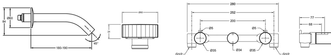
Descriptif CCTP : Mélangeur mural 3 trous poignées Marbre Sculptural. CE27341-LM-HYC. Collection : GRANDS BOULEVARDS. POIDS : 1,0 kg. MATÉRIAU : Laiton. TYPE D'INSTALLATION : Mural. TYPE : Mélangeur. DÉBIT (L/MN SOUS 3 BAR) : 5 l/mn. SAILLIE DU BEC (MM) : 180. RACCORDS : Avec flexibles d'alimentation. VIDAGE : Sans. TYPE DE BEC : Coudé. GARANTIE MÉCANISME : 5 ans. DURÉE GARANTIE (ANNÉES) : 5.
