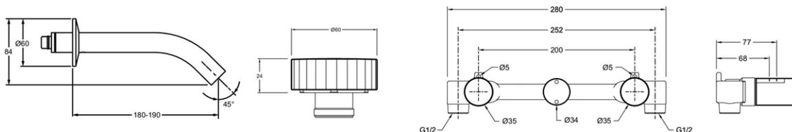
Descriptif CCTP : Mélangeur mural 3 trous, poignées douceur minérale. CE27341-LM-HYJ. Collection : GRANDS BOULEVARDS. POIDS : 1,0 kg. MATÉRIAU : Laiton. TYPE D'INSTALLATION : 3 trous. TYPE : Mélangeur. DÉBIT (L/MN SOUS 3 BAR) : 5 l/mn. SAILLIE DU BEC (MM) : 180. RACCORDS : Avec flexibles d'alimentation. VIDAGE : Sans. TYPE DE BEC : Coudé. GARANTIE MÉCANISME : 5 ans. DURÉE GARANTIE (ANNÉES) : 5.
