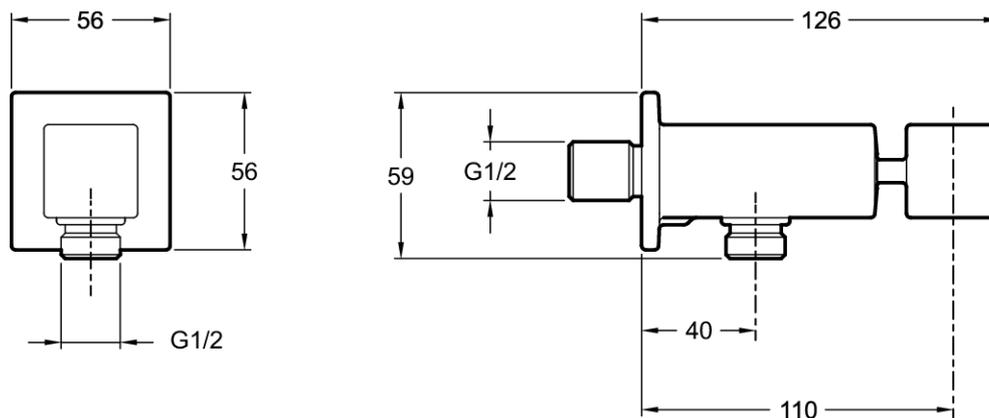
Descriptif CCTP : Coude de raccordement. E14791. Collection : Hors collection. POIDS : 0,8 kg. MATÉRIAU : Métal. TYPE D'INSTALLATION : Mural. TYPE D'ACCESSOIRE : Coude de raccordement. CLAPET ANTI-RETOUR : Oui. DURÉE GARANTIE (ANNÉES) : 2.
