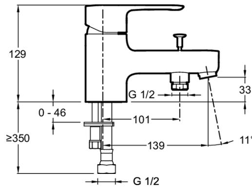
Descriptif CCTP : Mitigeur bain-douche. E16044-4. Collection : JULY. POIDS : 1,5 kg. MATÉRIAU : Métal. TYPE D'INSTALLATION : 1 trou. NORMES ET RÉGLEMENTATIONS : NF : IC/A - ECAU : E3/1 C2 A2 U3 - Ge3. TYPE : Mitigeur DÉBIT (L/MN SOUS 3 BAR) : 21 l/mn. RACCORDS : Avec flexibles d'alimentation. MÉCANISME : Cartouche à disques céramique. ECO CONSO : Oui. VIDAGE : Sans. INVERSEUR : Automatique verrouillable. GARANTIE MÉCANISME : 5 ans. DURÉE GARANTIE (ANNÉES) : 5. Aérateur anti-calcaire..
