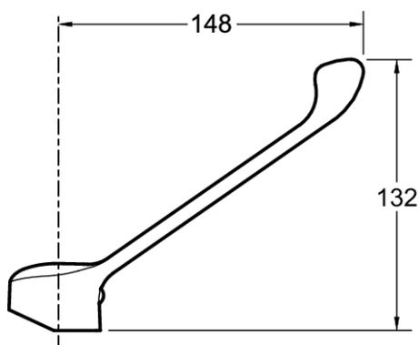
Descriptif CCTP : Levier à commande au coude. E18164. Collection : EASY. POIDS : 0,2 kg. MATÉRIAU : Métal. DURÉE GARANTIE (ANNÉES) : 2. Levier long pour commande à coude.
