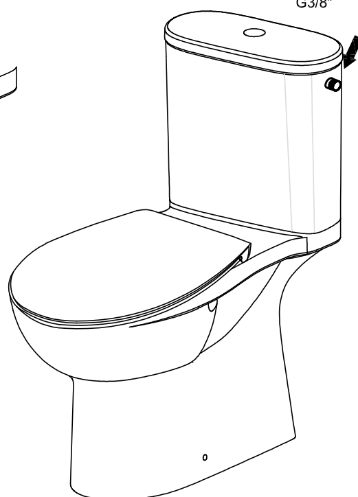
6- RACCORDER L'ARRIVEE D'EAU. G3/8"
