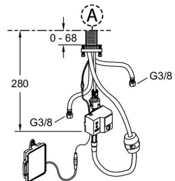
Descriptif CCTP : Mitigeur évier à détection électronique. E26180. Collection : FORTE. POIDS : 1,3 kg. MATÉRIAU : Métal. TYPE D'INSTALLATION : 1 trou. TYPE DE FLEXIBLE : Nylon tressé. TYPE : Mitigeur. DÉBIT (L/MN SOUS 3 BAR) : 7 l/mn. HAUTEUR TOTALE DU ROBINET (MM) : 383. TYPE DE ROBINETTERIE DE CUISINE : Sans contact. TYPE DE BEC : Col de cygne. GARANTIE MÉCANISME : 5 ans. GARANTIE FINITION : 25 ans. DURÉE GARANTIE (ANNÉES) : 5.
