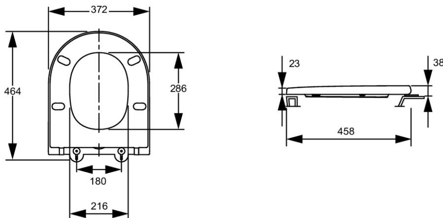
Descriptif CCTP : Abattant recouvrant à descente progressive. E34201. Collection : BASTILLE. DIMENSIONS : 46,40 x 37,20 cm. MATÉRIAU : Thermodur. TYPE D'ABATTANT : Recouvrant. ABATTANT : A descente progressive et déclinable. CHARNIÈRES : Métal. ABATTANT ANTIBACTÉRIEN : Non. GARANTIE DE L'ABATTANT : 2 ans. CONDITIONNEMENT : 1 colis.
