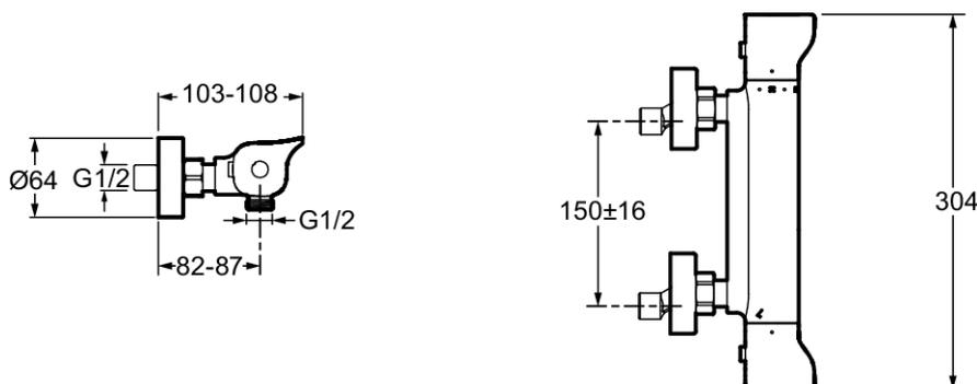
Descriptif CCTP : Mitigeur thermostatique douche. E37976-9. Collection : AURORE. DIMENSIONS : 10,80 x 6,40 cm. POIDS : 2,1 kg. MATÉRIAU : Laiton. TYPE D'INSTALLATION : 2 trous. CONSOMMATION D'EAU : Limiteur de débit sensitif. TYPE : Mitigeur. DÉBIT (L/MN SOUS 3 BAR) : 12 l/mn. RACCORDS : Avec raccords et rosaces murales. MITIGEUR DE DOUCHE : Thermostatique. BUTÉE DE SÉCURITÉ : 38°C. TEMPÉRATURE MAXI : 50°C. CORPS TIÈDE : Oui. GARANTIE MÉCANISME : 5 ans. DURÉE GARANTIE (ANNÉES) : 5.
