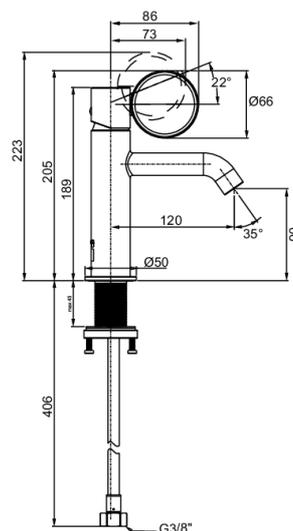
Descriptif CCTP : Mitigeur standard - Bijou Noir Mat. E38682-LB2. Collection : VIVIENNE SIGNATURE. DIMENSIONS : 5 x 20,50 cm. POIDS : 1 kg. MATÉRIAU : Métal. TYPE D'INSTALLATION : 1 trou. TYPE : Mitigeur. DÉBIT (L/MN SOUS 3 BAR) : 5 l/mn. RACCORDS : Avec flexibles d'alimentation. GARANTIE MÉCANISME : 5 ans. DURÉE GARANTIE (ANNÉES) : 5.
