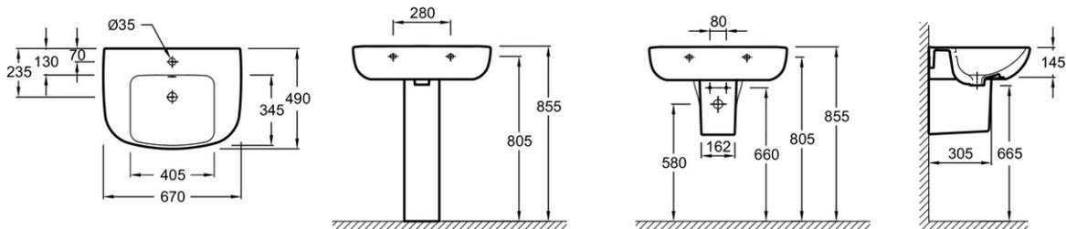
Descriptif CCTP : Lavabo 67 cm. E4754C. Collection : ODÉON UP. DIMENSIONS : 67 x 49 cm. POIDS : 19,6 kg. MATÉRIAU : Céramique. TYPE D'INSTALLATION : Autoportant. NORMES ET RÉGLEMENTATIONS : NF ; FDES. CONFIGURATION : Standard. PERCEMENT ROBINETTERIE : 1 trou. TROP-PLEIN : Avec trou de trop-plein. ROBINETTERIE CONSEILLÉE : Aleo. DURÉE GARANTIE (ANNÉES) : 10. INFORMATIONS COMPLÉMENTAIRES : Bonde et robinetterie non incluses.
