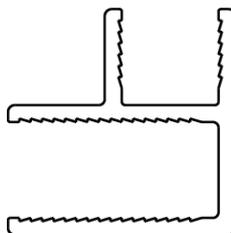
Descriptif CCTP : Profilé d'angle. E63005. Collection : PANOLUX. DIMENSIONS : 255 cm. POIDS : 0,3 kg. MATÉRIAU : Aluminium. TYPE D'INSTALLATION : Mural. TYPE D'ACCESSOIRE : Profilé. HAUTEUR DES PAROIS EN CM : 255. REDÉCOUPABLE : Oui. DURÉE GARANTIE (ANNÉES) : 10.
