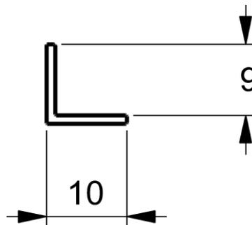
Descriptif CCTP : Profilé d'angle. E66021. Collection : PANOSTYLE. DIMENSIONS : 255 x 1 cm. POIDS : 1,2 kg. MATÉRIAU : Aluminium. TYPE D'INSTALLATION : Mural. TYPE D'ACCESSOIRE : Profilé. HAUTEUR DES PAROIS EN CM : 255. REDÉCOUPABLE : Oui. COULEUR DES PROFILÉS : Chrome ; Noir mat ; Blanc mat. DURÉE GARANTIE (ANNÉES) : 5.
