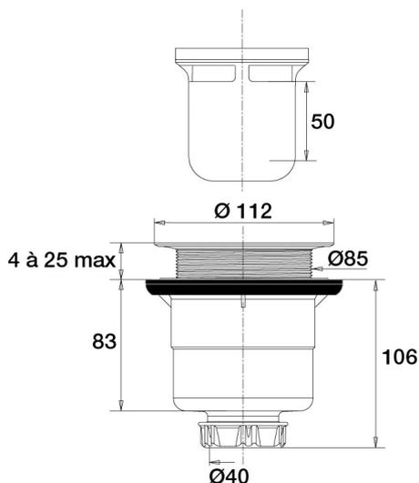
Descriptif CCTP : Bonde verticale sans capot. E6760. Collection : Hors collection. MATÉRIAU : N/A. TYPE D'ACCESSOIRE : Bonde. ANTIDÉRAPANT : Non. DIAMÈTRE DE BONDE (CM) : 9. DURÉE GARANTIE (ANNÉES) : 2. CAPOT : non livré. DÉBIT : 45 l/mn. SORTIE : 40 mm à visser ou à coller. GARDE D'EAU : 50 mm.
