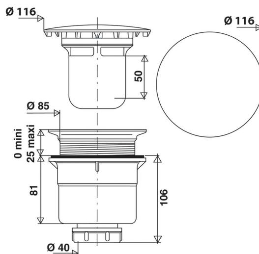
Descriptif CCTP : Bonde verticale. E6761. Collection : Hors collection. POIDS : 0,3 kg. MATÉRIAU : N/A. TYPE D'ACCESSOIRE : Bonde. ANTIDÉRAPANT : Non. DIAMÈTRE DE BONDE (CM) : 9. DURÉE GARANTIE (ANNÉES) : 2. CAPOT : acier inoxydable. DÉBIT : 45 l/mn. SORTIE : 40 mm à visser ou à coller. GARDE D'EAU : 50 mm.
