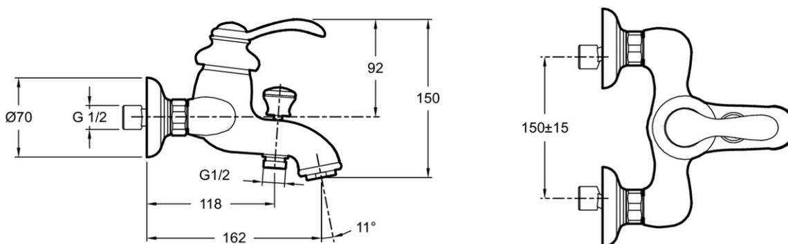
Descriptif CCTP : Mitigeur bain-douche mural. E71090. Collection : FAIRFAX. DIMENSIONS : 15 cm. POIDS : 2,2 kg. MATÉRIAU : Métal. TYPE D'INSTALLATION : 2 trous. TYPE : Mitigeur. DÉBIT (L/MN SOUS 3 BAR) : 20 l/min. SAILLIE DU BEC (MM) : 150. RACCORDS : Avec raccords colonnettes pour montage rapide à joints toriques. MÉCANISME : Cartouche en céramique. GARANTIE FINITION : 10 ans. DURÉE GARANTIE (ANNÉES) : 5. Mitigeur de style rétro. Aérateur anti-calcaire.
