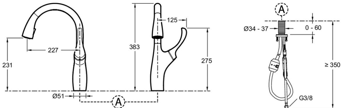
Descriptif CCTP : Mitigeur de cuisine, bec tube orientable. E72511. Collection : SUZANNE. DIMENSIONS : 38,30 cm. POIDS : 1,1 kg. MATÉRIAU : Métal. TYPE D'INSTALLATION : 1 trou. DÉBIT (L/MN SOUS 3 BAR) : 7 l/min. HAUTEUR TOTALE DU ROBINET (MM) : 383. SAILLIE DU BEC (MM) : 231. RACCORDS : Avec flexibles d'alimentation. GARANTIE MÉCANISME : 5 ans. GARANTIE FINITION : 10 ans. DURÉE GARANTIE (ANNÉES) : 5.
