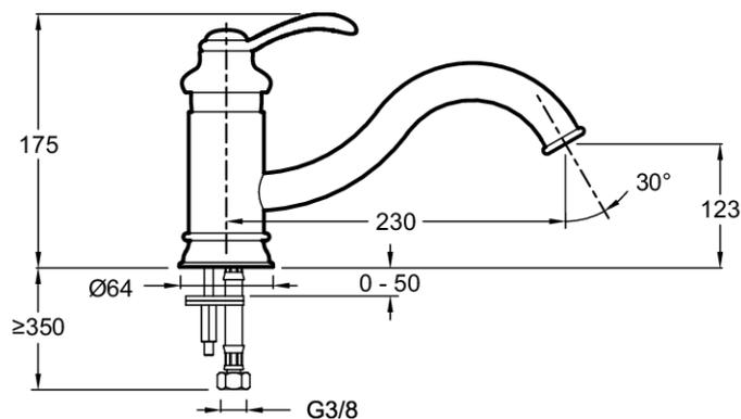
Descriptif CCTP : Mitigeur évier, bec tube. E76090. Collection : FAIRFAX. DIMENSIONS : 17,50 cm. POIDS : 1,9 kg. MATÉRIAU : Métal. TYPE D'INSTALLATION : 1 trou. TYPE : Mitigeur. DÉBIT (L/MN SOUS 3 BAR) : 13 l/min. SAILLIE DU BEC (MM) : 230. RACCORDS : Avec flexibles d'alimentation. MÉCANISME : Cartouche à disques céramique. DURÉE GARANTIE (ANNÉES) : 5. Bec tube orientable.
