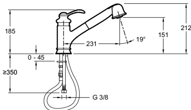
Descriptif CCTP : Mitigeur évier, douchette extractible. E76091. Collection : FAIRFAX. DIMENSIONS : 21,60 cm. POIDS : 2,6 kg. MATÉRIAU : Métal. TYPE D'INSTALLATION : 1 trou. TYPE : Mitigeur. DÉBIT (L/MN SOUS 3 BAR) : 7 l/mn. SAILLIE DU BEC (MM) : 231. RACCORDS : Avec flexibles d'alimentation. MÉCANISME : Cartouche à disques céramique. DURÉE GARANTIE (ANNÉES) : 5. Bec orientable douchette extractible. Douchette avec 2 jets. Aérateur anti-calcaire.
