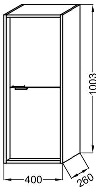
Descriptif CCTP : Demi-colonne 40 cm, réversible - 2 portes, poignée Chrome. EB1510-M90. Collection : VIVIENNE. DIMENSIONS : 40 x 26 x 100,30 cm. POIDS : 19 kg. MATÉRIAU : Laque et mélaminé. TYPED'INSTALLATION : Suspendu. COLORIS POIGNÉE : Chrome. TYPE MEUBLE DE COMPLÉMENT : Colonne. DURÉE GARANTIE (ANNÉES) : 5.
