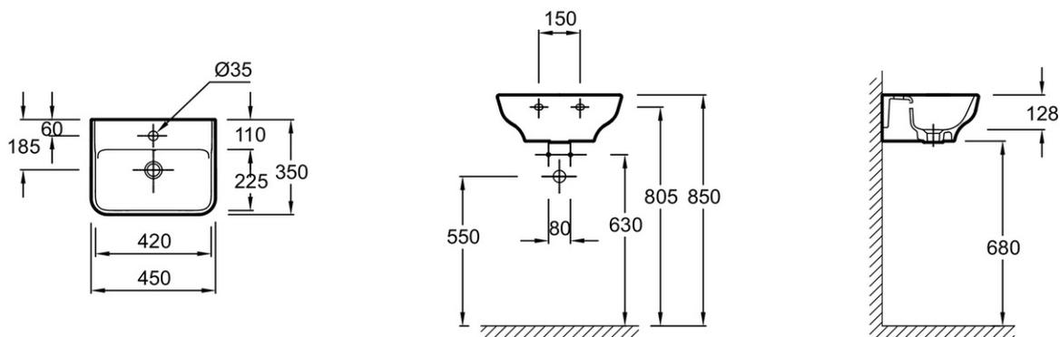
Descriptif CCTP : Lave-mains 45 cm, non meulé. EGH112. Collection : STRUKTURA. DIMENSIONS : 45 x 35 cm. POIDS : 9 kg. MATÉRIAU : Céramique. TYPE D'INSTALLATION : Autoportant. PERCEMENT ET PRÉ-PERCEMENT ROBINETTERIE : 1. PERCEMENT ROBINETTERIE : 1 trou. MEULÉ/NON-MEULÉ : Non meulé. TROP-PLEIN : Avec trou de trop-plein. DURÉE GARANTIE (ANNÉES) : 10. INFORMATIONS COMPLÉMENTAIRES : Bonde et robinetterie non incluses.
