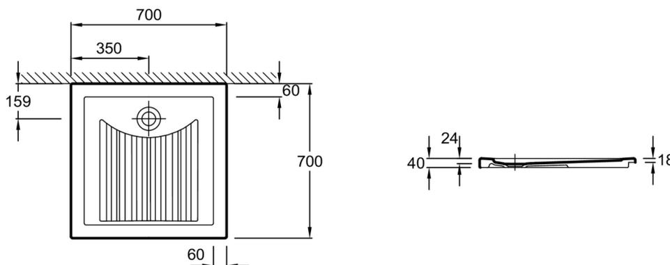
Descriptif CCTP : Receveur 70 x 70 cm. ENA60. Collection : KYRÉO. DIMENSIONS : 70 x 70 x 4 cm. POIDS : 18 kg. MATÉRIAU : Céramique. TYPE D'INSTALLATION : Encastré. NORMES ET RÉGLEMENTATIONS : NF. ANTIDÉRAPANT : Non. FORME : Carré. DIAMÈTRE DE BONDE (CM) : 6. MOTIF DE SURFACE : Relief. LIVRÉ AVEC BONDE : Non. DURÉE GARANTIE (ANNÉES) : 10.
