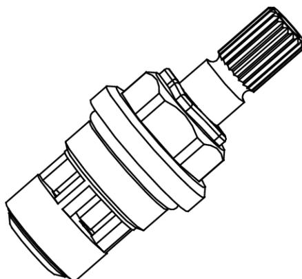
Descriptif CCTP : Tête à disques céramique. R8A370NF. Collection : Hors collection. POIDS : 0,6 kg. MATÉRIAU : N/A. TYPE D'ACCESSOIRE : Tête de mélangeur. GARANTIE MÉCANISME : 5 ans. DURÉE GARANTIE (ANNÉES) : 5.
